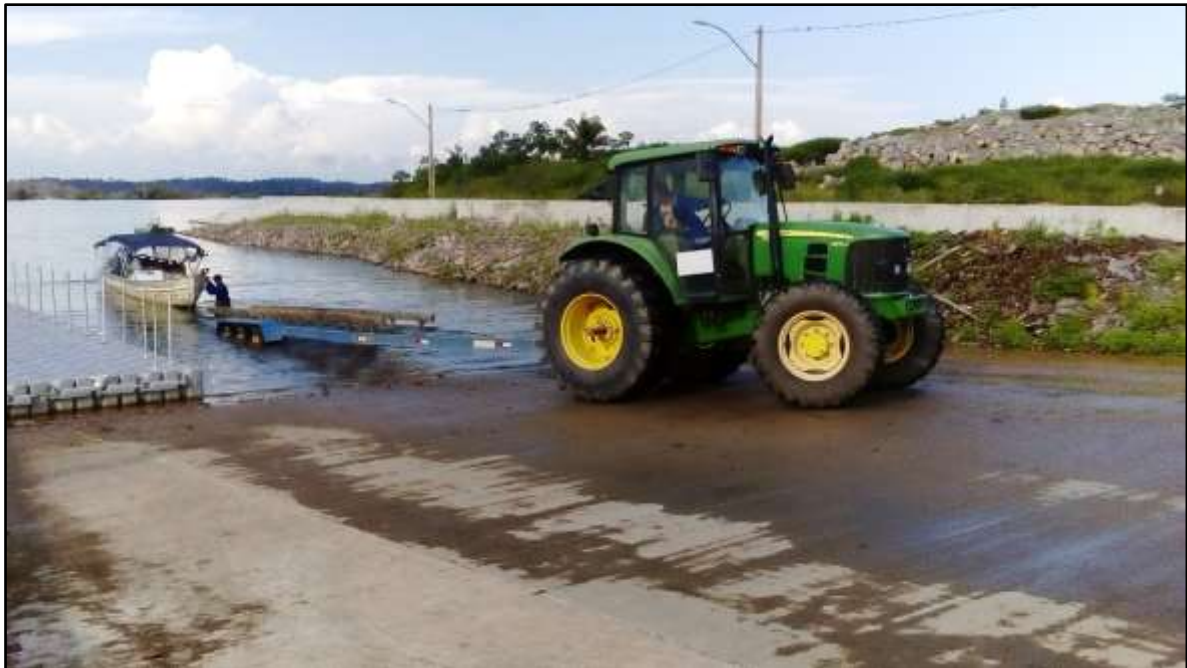
Fotografia 10- Içamento para transposição de pequena embarcação tipo voadeira. Ação mitigatória do efeito causado pela usina na navegação tradicional do Xingu.
