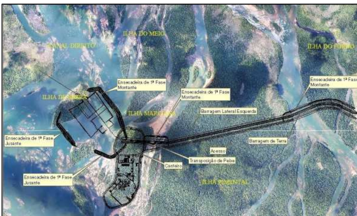
Figura 2- Ilustração trata da instalação de ensecadeiras em cinco grandes ilhas no primeiro ano de obras da usina Belo Monte, a jusante de Altamira.
