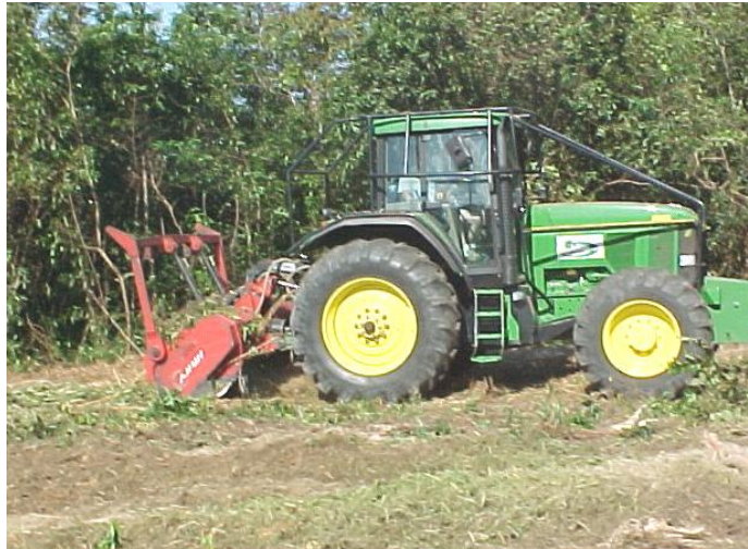
Figura 3. Fresador Ahwi triturando capoeira em estabelecimento agrícola familiar do município de Igarapé-Açu-Pa, 2001.
